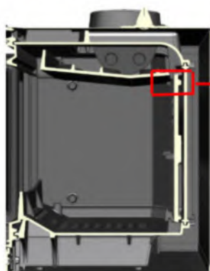
3 : Poser le déflecteur sur le haut de la plaque décor (Vue en coupe)
